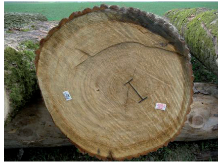
Abbildung - 6: Ungleichmäßiger Farbaufbau 13
