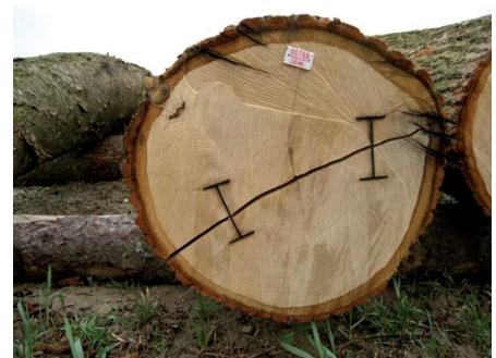
Abbildung - 9: Kernriss, welcher mit Metallklammern zusammengehalten wird 13
